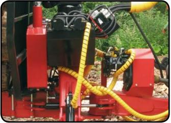
Защита гидравлического бака обеспечена его расположением между погрузочным манипулятором и оградительной решеткой. Коробка передач и гидронасос с регулировочным объемом (постоянным давлением) размещены на дышле грузового прицепа. Как манипулятор так и грузовой погрузчик можно использовать с той же гидравликой так, что они будут полностью независимы от гидравлической системы трактора.
