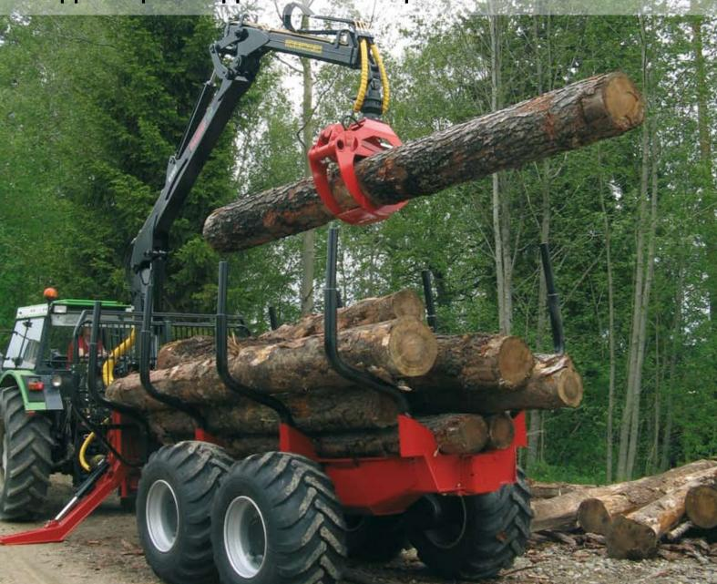
У PROFDRIVE 12-4WD тяговое усилие 51 кН (5,1 т) и грузоподьемность 12 т. Оснащенный манипулятором FARMI и подключенный к 4-тяговому трактору этот грузовой прицеп с буксировочной втулкой становится передвижным подъемным краном для лесной промышленности. PROFDRIVE 12-4WD спроектирован для профессионального использования, учитывая его производственные характеристики, ваш трактор можно легко преобразовать в эффективный комплекс для транспортировки древесины.
